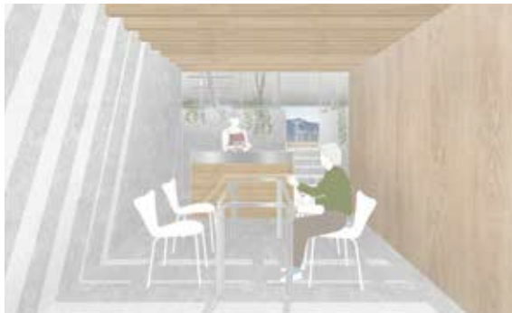
半地下のダイニング。質量、厚みを持ったコンクリートと温かみのある木材に囲まれた落ち着いた空間。大地の蓄熱効果により年中安定した温熱環境を享受する。
