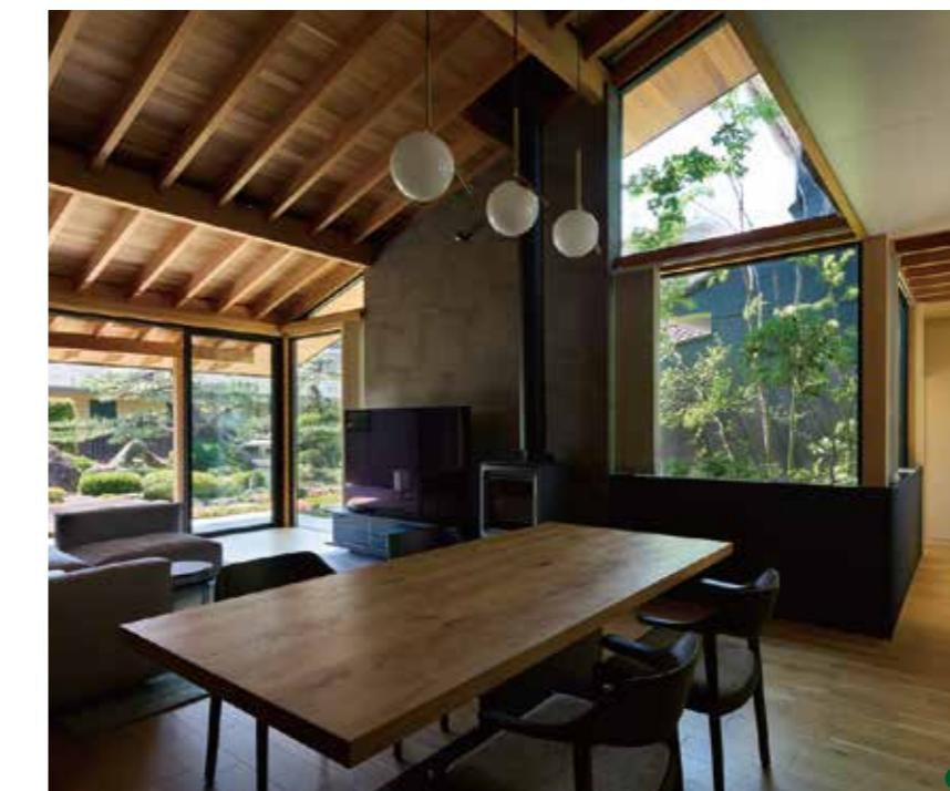
②③④各階の小屋裏をなくし、屋根勾配なりの勾配天井とした。1階の天井と2階の床のすれの隙間に可動ルーバーを設置。ルーバーの開放時は2階の回廊まで視線が通り抜け、ルーバーを閉じることでLDKの熱環境を調整できる。
