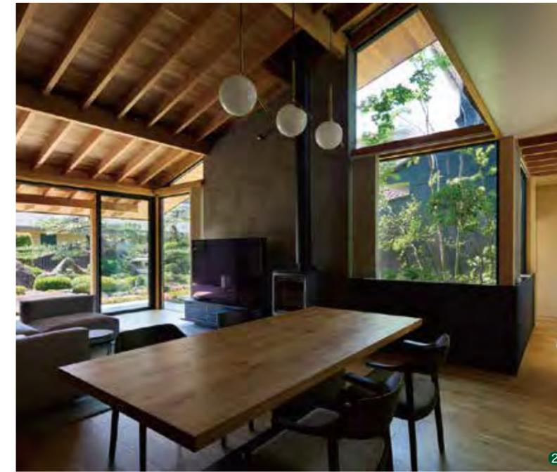
②③④各階の小屋裏をなくし、屋根勾配なりの勾配天井とした。1階の天井と2階の床のずれの隙間に可動ルーバーを設置。ルーバーの開放時は2階の回廊まで視線が通り抜け、ルーバーを閉じることでLDKの熱環境を調整できる。
