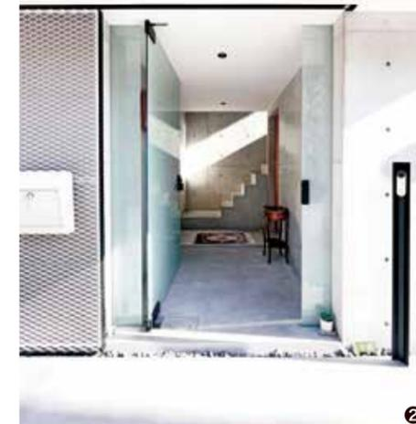
①間口の広い敷地に対して、奥行き二間の建物を目一杯配置。空間を純粋に楽しむためにも柱や梁型は隠し、構造形式は壁式構造とした。各空間の用途に合わせて、高さは構造上の上限階高4mをマックスに決定し配置した。
