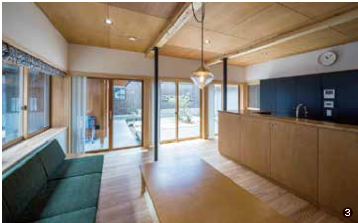
③構造材・内部造作化粧材は鳥取県産のスギ材を使用し、地産地消・脱炭素化に努めた。開口部は全てLowEガラスとし、1階広間の南面開口部は断熱サッシとすることで冬季の日射を有効に取り込む。 ④ロフトのある2階寝室。自然通風を可能とするため全ての居室に2面開口を用意。南北を軸に並ぶ2階にはロフトに換気窓を設け、南風を通し重力換気による通風を実現。寝室の横のインナーバルコニーは、降雨の多いこの地域では風の抜ける物干し場となる。
