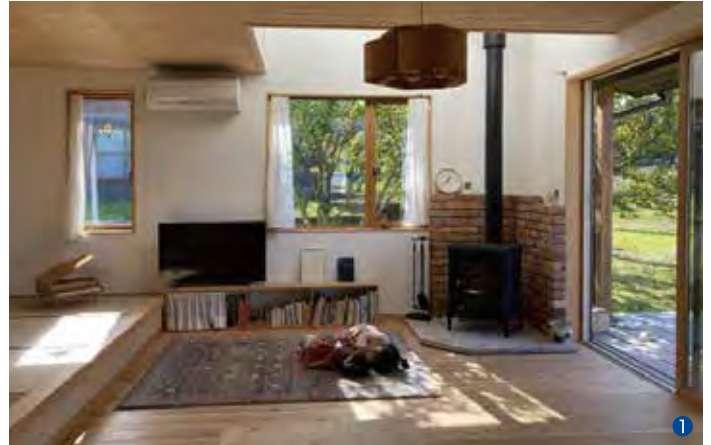
①リビング西面の大きな開口部には深い庇をつけ、夏の日除けに。一方で、南面の開口部はLowE断熱タイプにし、庇をくぐり差し込む西日とともに、冬場の日射熱を有効に取り込む。
