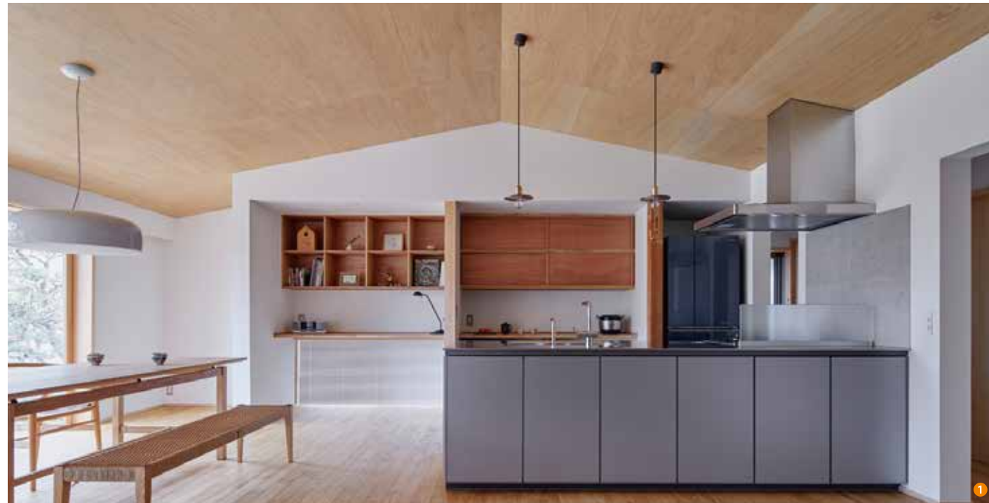
①居間スペースより食事室、台所をみる。既存軸組内にラワン合板の切妻型天井を納めた。
