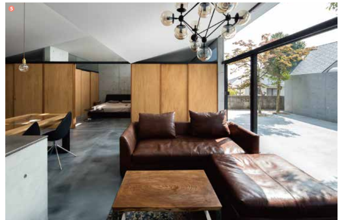
③上部ランマによる重力換気を利用し、エアコンによる空調管理に加え自然換気を積極的に導入。留守中の愛犬の生活環境向を図ると共に、省エネ・省CO 2 にも有効。 ④季節や時刻により刻々と変化する日差しと風を感じることができる、上部ランマ。自然をより身近に感じながら快適な暮らしができるように配慮。 ⑤斜めの屋根スラブによって、北側の趣味空間への採光を確保。南面では外部空間への誘いを促し、北面ではプライバシーを確保。愛犬との暮らし、趣味の暮らし、普段の暮らし。それぞれの暮らしがバランスよく調和する住まいが実現した。
