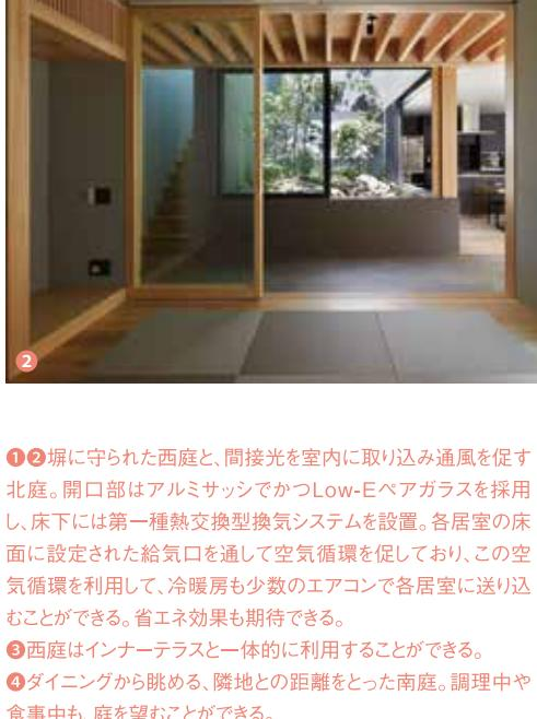
①②堀に守られた西庭と、間接光を室内に取り込み通風を促す北庭。開口部はアルミサッシでかつLow-Eペアガラスを採用し、床下には第一種熱交換型換気システムを設置。各居室の床面に設定された給気口を通して空気循環を促しており、この空気循環を利用して、冷暖房も少数のエアコンで各居室に送り込むことができる。省エネ効果も期待できる。
