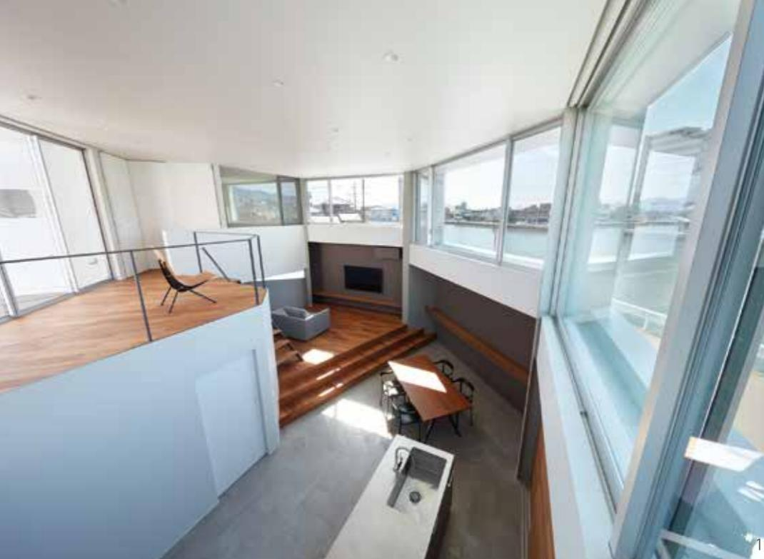
1.省エネを実現するために、開口部はアルミサッシかつLow-Eペアガラスを採用。南向きの開口部は高さ寸法を抑え、山並みの景色側の開口を大きくすることで、日射と眺望をコントロールしています。大きな吹抜けのLDKの床は温水式床暖房を敷くことで、冬期は足下からの暖かさを感じる空間としました。
